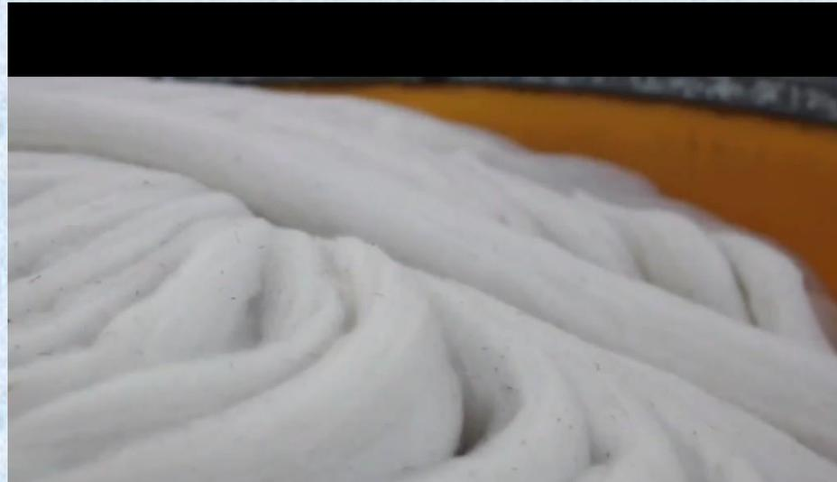
Dopo l'asciugatura vengono classificati e pettinati fino ad ottenere dei nastri dai quali si otterrà il filato. La tintura può avvenire quando le fibre sono ancora in forma di nastro oppure quando sono state filate o tessute.
